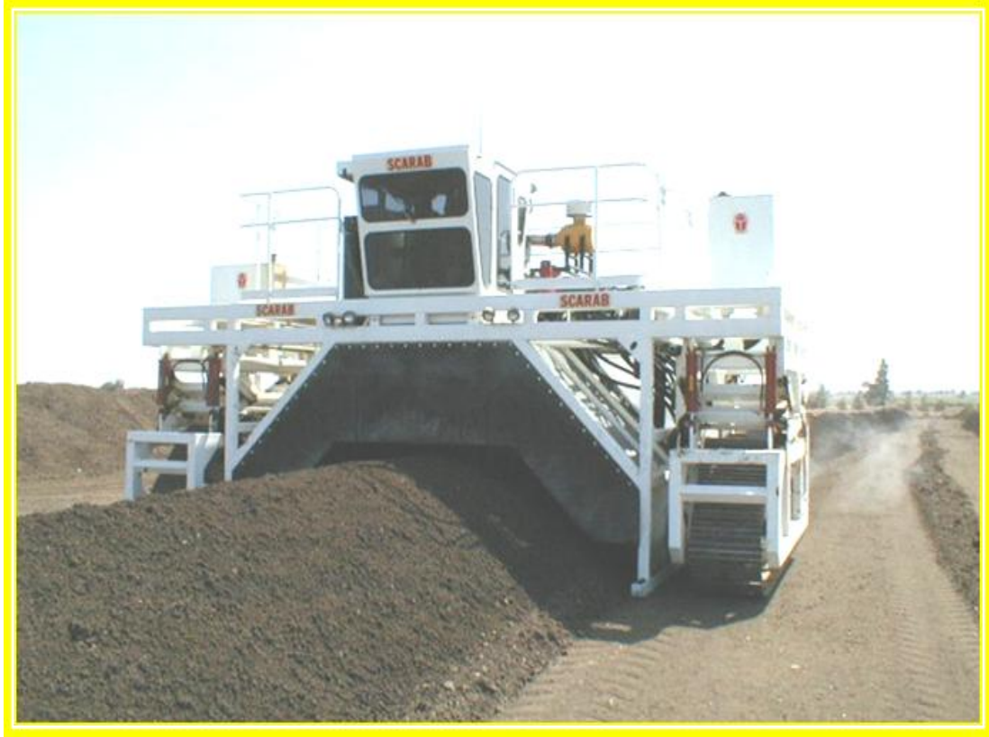
صور رقم ٨ توضح شكل مصفوفة الحمأة وعمليات التقلب الميكانيكي
